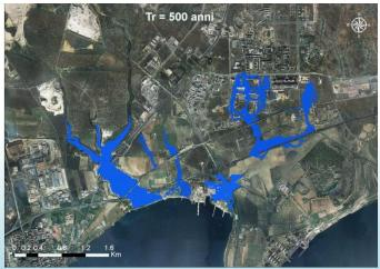
Simulazione idraulica bidimensionale
