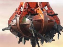
Rimozione dei *marine litter* tramite benna a ragno di tipo *orange-peel*.
