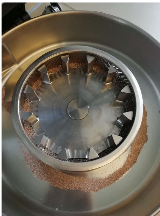
Figura 5. Preparazione del campione di metalli per l'analisi chimica
