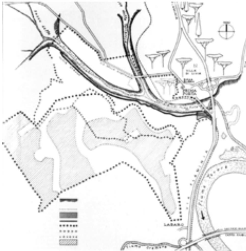
*Figura 2* | Perimetrazione del PdZ ex l. 167/1962 previsto nel 1964; il perimetro punteggiato individua l'area destinata alla nuova edificazione, mentre il perimetro a crocette definisce l'ambito di recupero urbanistico, con la demolizione dell'edilizia fatiscente esistente e la realizzazione dei nuovi argini dei fossi. Fonte: Camaleone E. (1966).
