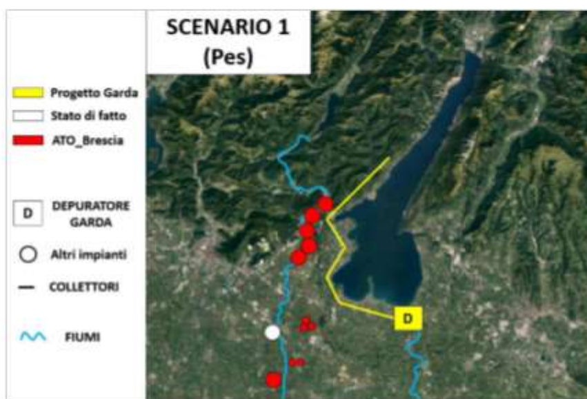
Figura 2: Scenario 1 (Pes): rappresentazione schematica del tracciato del nuovo sistema di collettamento e dell'ubicazione dei depuratori a servizio dell'intero bacino
