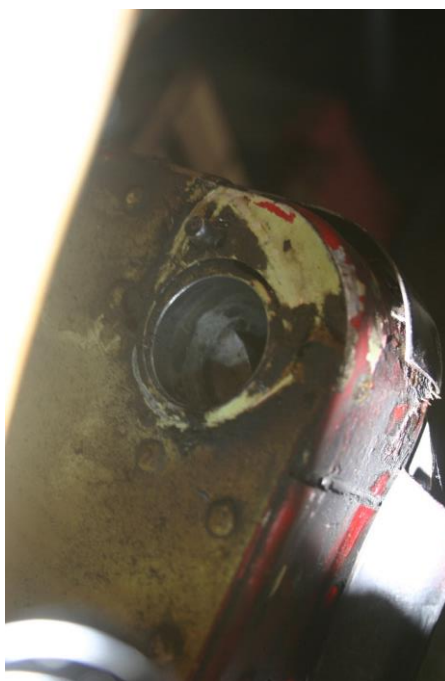
Foto 9: il punto di fissaggio del cilindro di sblocco in emergenza con la ghigliottina di blocco/sblocco.
