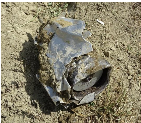
Foto 14: il regolatore del passo dell'elica.
