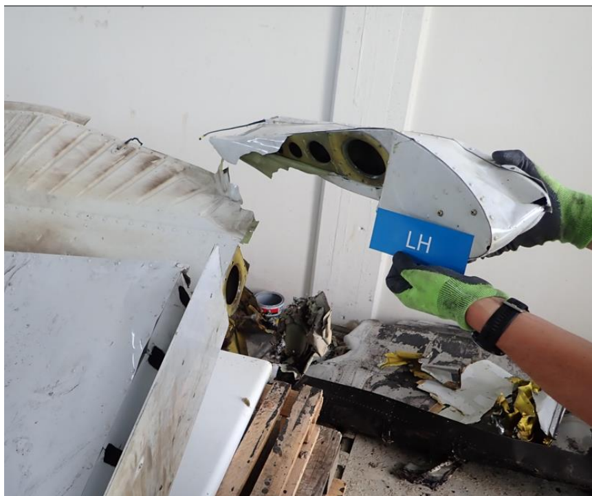
Foto 31: estremità sinistra dell'elevatore contenente all'interno il contrappeso.
