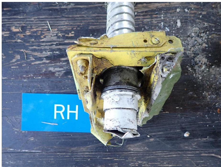
Foto 34: attuatore meccanico del flap destro.
