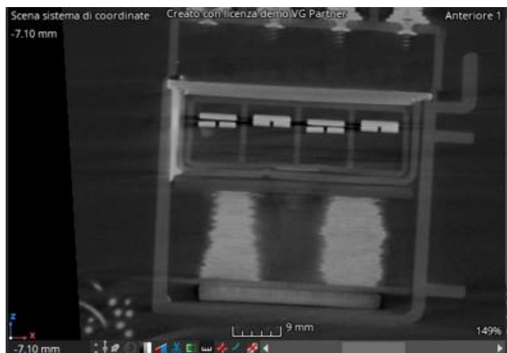
Foto 61: down relè - contatti A2-A3 e C2-C3 in posizione di apertura (normalmente chiusi).
