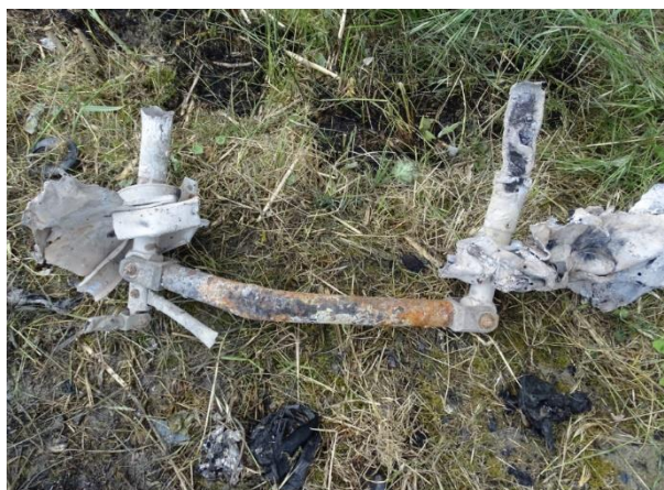
Foto 23: particolare delle barre di comando (porzioni inferiori e barra di collegamento).
