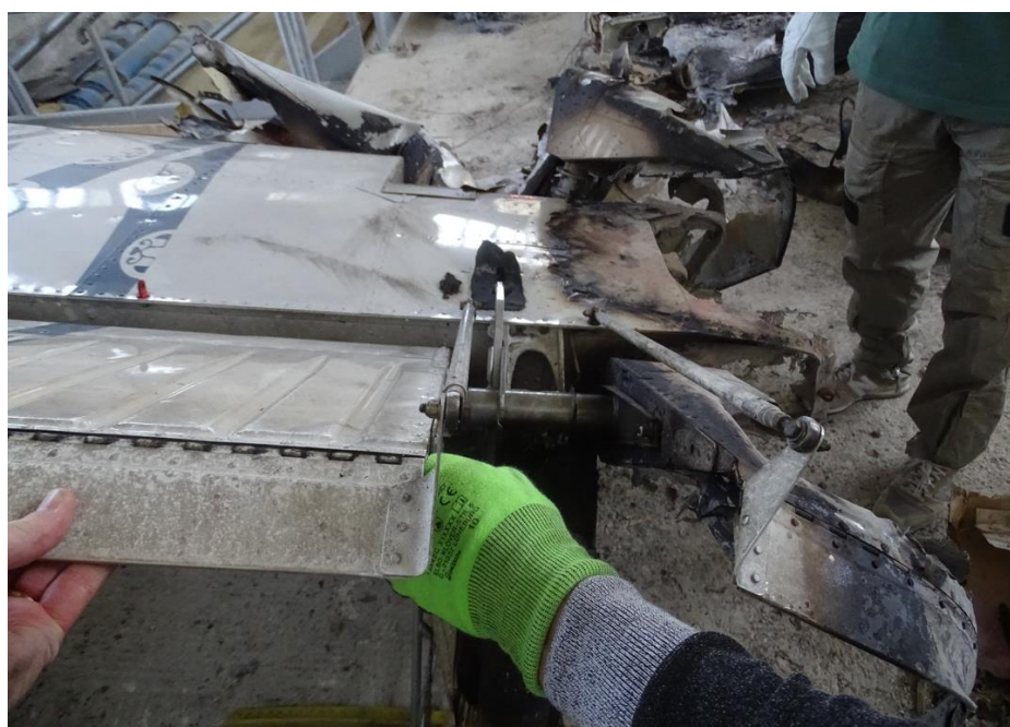
Foto 30: particolare del meccanismo di bilanciamento ( elevator balance tab ).
