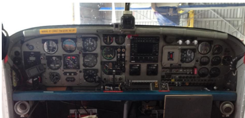
Foto 3: vista del cockpit del PC-6T I-HSKC (in configurazione singolo pilota con comandi di destra rimossi, a differenza della configurazione dell'incidente che aveva entrambi i comandi installati per attività istruzionale a doppio comando).
