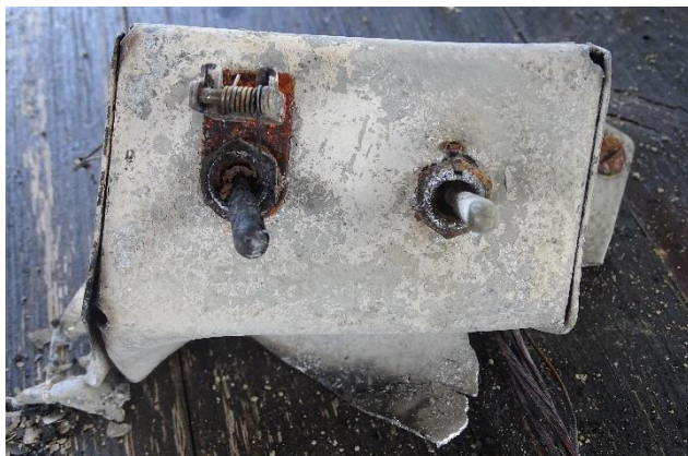
Foto 41: pannello relativo all'interruttore trim interrupt e dell'alternate stabilizer trim system . L'interruttore trim interrupt , privo di guardiola, è in posizione normale.
