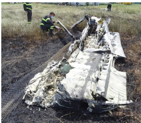
Foto 18: semi-ala sinistra rimasta incagliata alla recinzione metallica.
