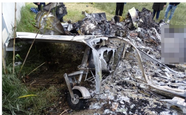
Foto 24: vista posteriore dei piani di coda
