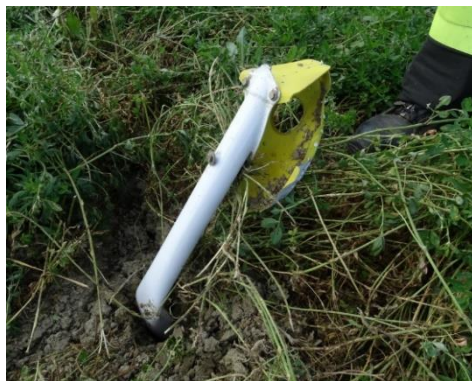
Foto 13: il bilanciere dell'alettone della semi-ala destra.
