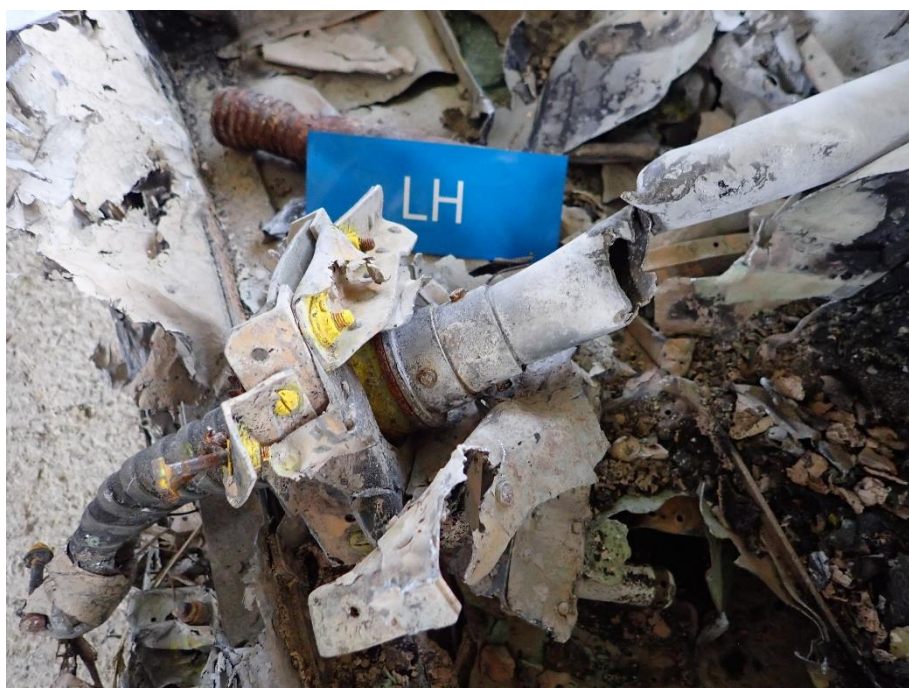
Foto 33: attuatore meccanico del flap sinistro.
