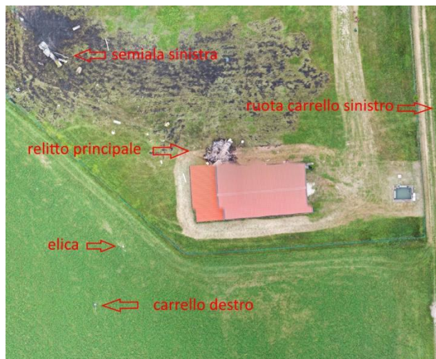
Foto 17: georeferenziazione da ortofoto drone VVF con evidenza di alcune parti significative.
