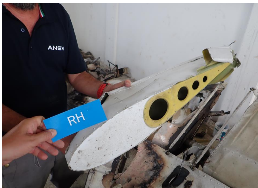
Foto 32: estremità destra dell'elevatore contenente all'interno il contrappeso.
