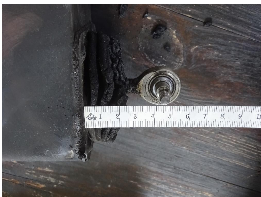
Foto 39: misurazione della estensione dell'attuatore, indicante la sua completa retrazione.
