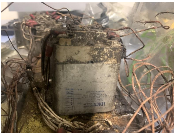
Foto 59: relè Leach p/n 9274-6205 rimossi dai resti del velivolo.
