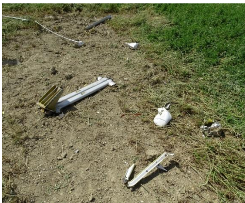
Foto 15: la trave superiore del carrello principale.
