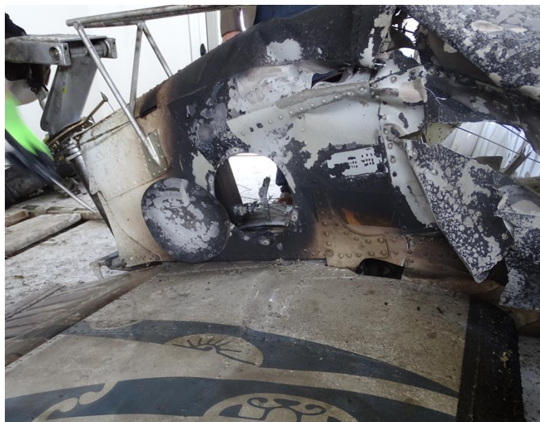
Foto 35: accesso all'attuatore del pitch trim (piano di coda capovolto per le operazioni di rimozione).
