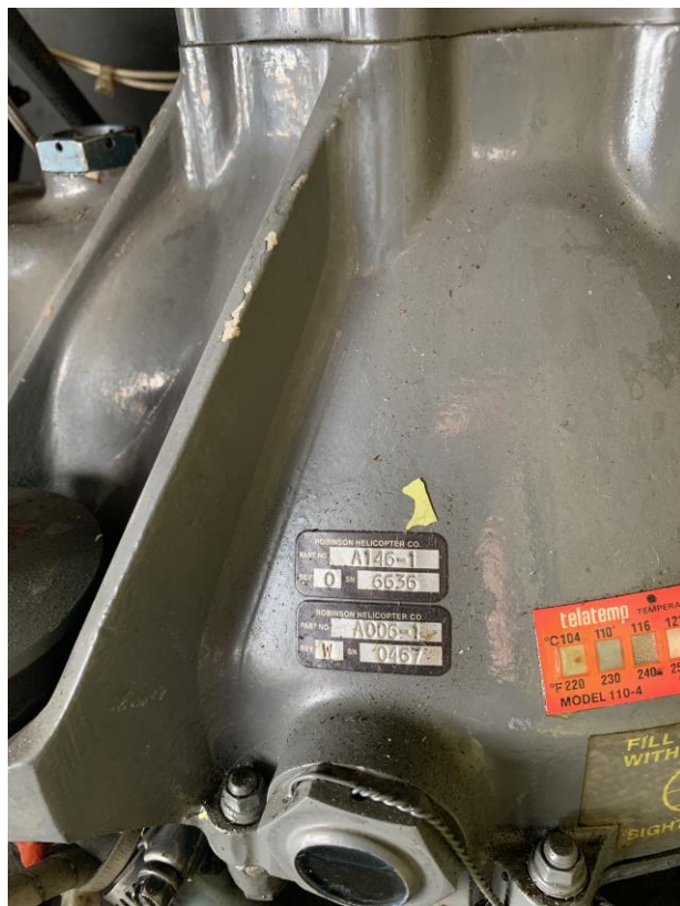
Foto 3, 4: a sinistra, particolare di alcuni SS/NN rinvenuti, testimoniati la produzione Robinson. A destra, la posizione dove è avvenuto il decollo del I-A189.
