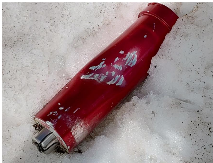
Foto 7: carica del paracadute balistico (fonte VVF).
