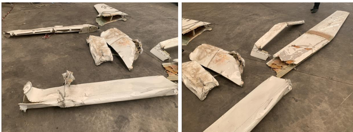
Foto 9 a sinistra e 10 a destra: superfici di governo, fusoliera e semiali.
