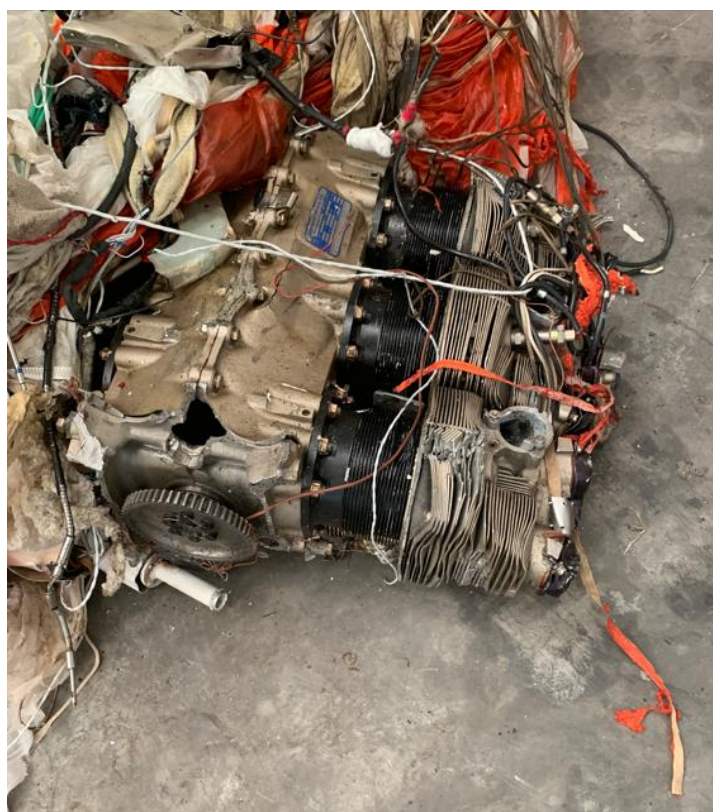
Foto 11: condizione del propulsore.
